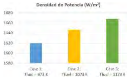
Figura 2. Efecto en la densidad de potencia.
