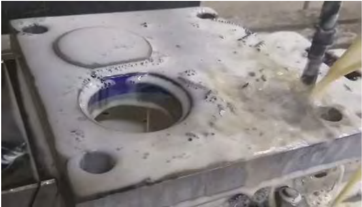
Figura 6. Maquinado de molde
