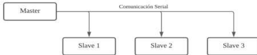
Figura 1. Protocolo de comunicación master-slave .
