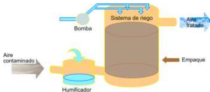
Figura 1. Esquema de un biofiltro de lecho fijo.
