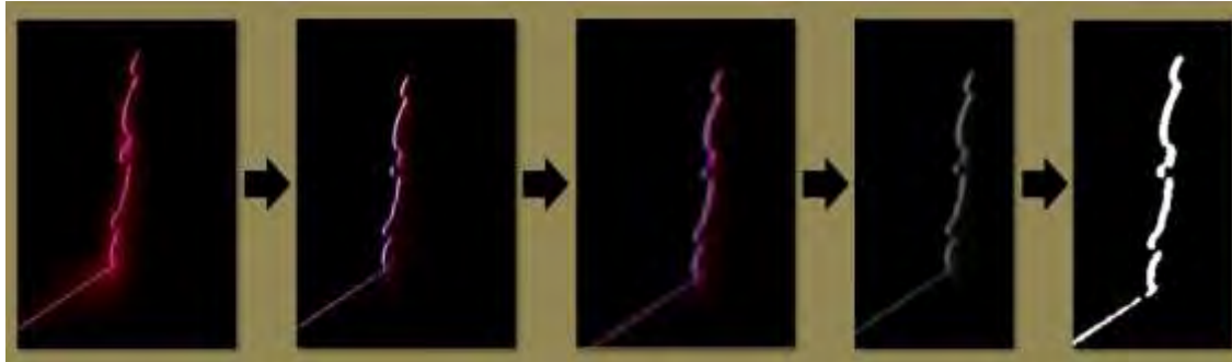
Figura 2. Reconstrucción digital aplicando digitalmente filtros para detección de bordes verticales, suavizado, mapeo a escala de grises y proceso de binarización.
