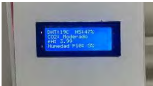
Figura 3. Pantalla de control de variables para soporte vital de las hortalizas.
