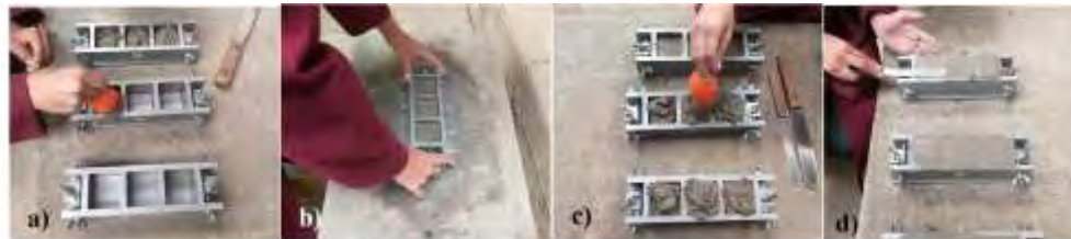
Figura 3.- Colado de las probetas cúbicas.
