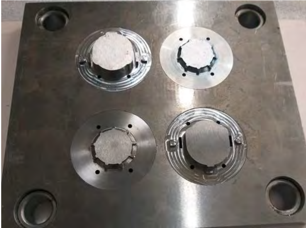
Figura 4 Manufactura de placa con corazones
