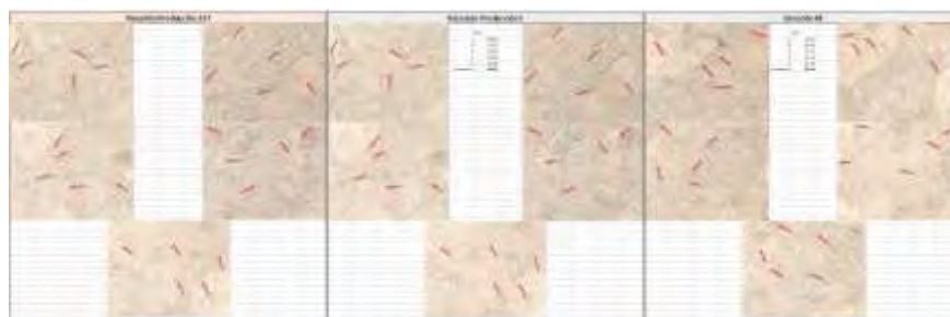
Figura 8. Mediciones DAS para estimar el tiempo de solidificación.
