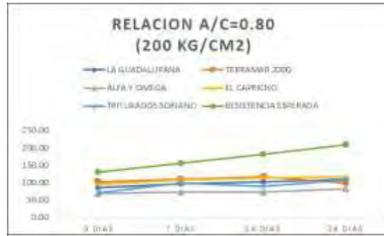
Fig 3. Resistencias a la compresión obtenida por bancos
