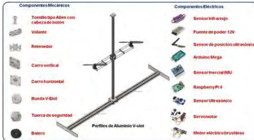
Figura 2 El PVTOL y sus principales componentes mecánicos y eléctricos
