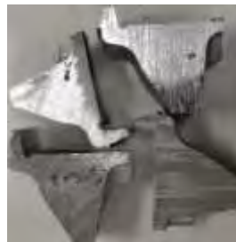
Figura 3. Cortes de sección de pieza con defectos en moldeo.
