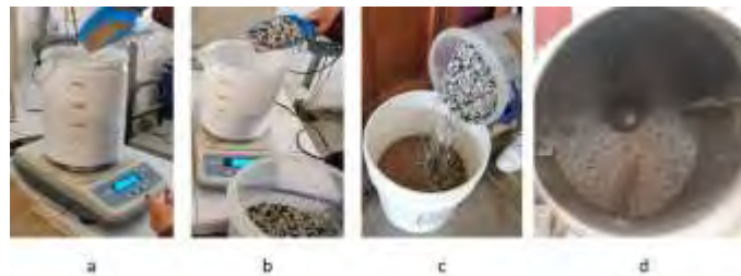
Figura 3. Preparación del agregado fino alternativo. a) Pesado de arena, b) pesado de RPAEE, c) adición de RPAEE a la arena, d) mezclado
