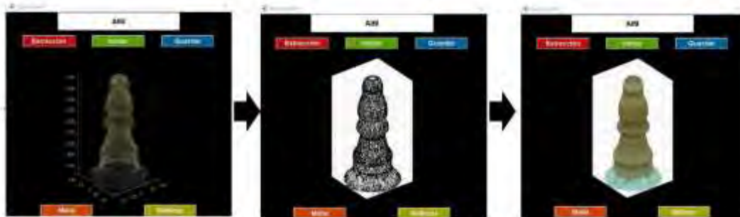
Figura 3. Proceso de modelado usando mallas triangulares de Delaunay y asignación de color
