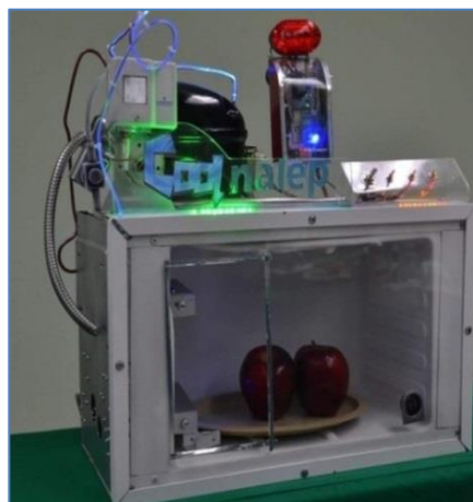
Figura 4. Prototipo domótico que permite la detención de fallas en tiempo real en sistemas de refrigeración
