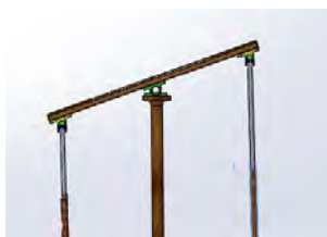
Figura 7.- Movimiento en conjunto de la celda solar con los tornillos de potencia.
