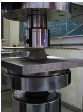
Figura 3. Ensayo de compresión en maquina universal Instron
