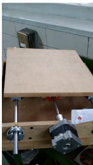
Figura 4. Construcción del eje X y del eje Y.
