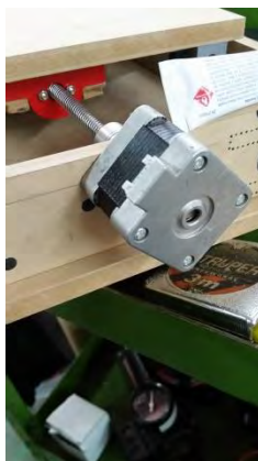
Figura 3. Adaptación de los motores, ejes y usillo.
