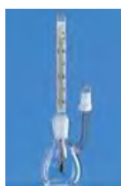
Figura 1. Picnómetro con termómetro. ( Brand®, 2015)
