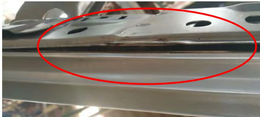
Figura 3. Punto de soldadura mal colocado por el operador por no seguir el estándar.
