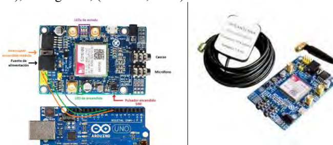
Figura 6. Integración de Arduino Uno, Modulo adaptador LCD a I2C, SIM808 y dos antenas GPRS-GPS.
