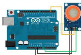
Figura 4. Diagrama de conexión arduino uno y sensor MQ3.
