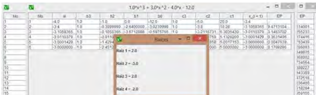
Figura 5. Raíces del polinomio por el método de Horner.
