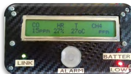
Figura 8. Módulo inalámbrico portátil de recepción de datos.
