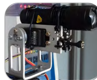
Figura 5. Sistema de iluminación y video IR.
