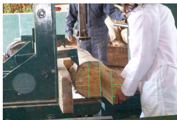
Figura 2. Aserrado en cruceta y zona de obtención de las probetas
