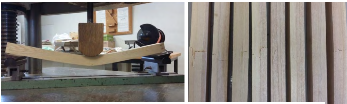
Figura 3. Ensayo de flexión estática y falla en las probetas ensayadas
