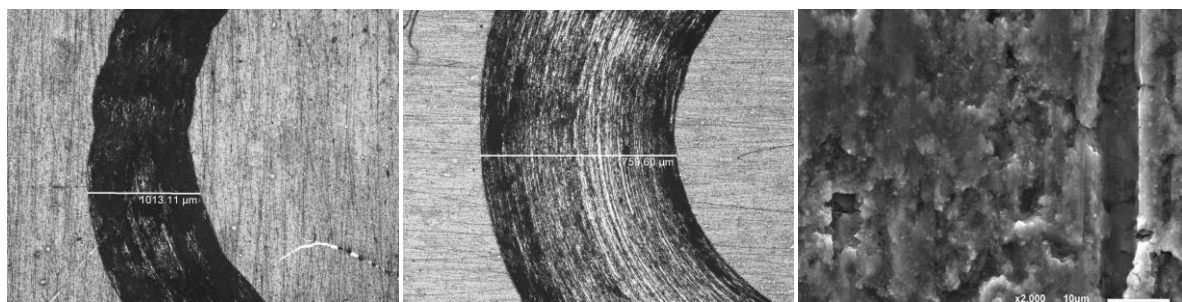
Figura 3 Imágenes ópticas de la huella de desgaste de la aleación AZ91E a 1 N a una velocidad de deslizamiento de a) 5cm/s, b) 15cm/s, c) Imagen MEB (15cm/s)
