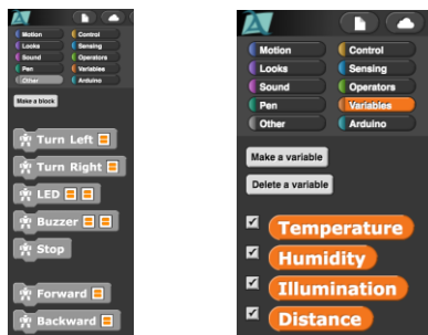
Figura 1: Nuevos bloques y variables en Snap4Arduino.
