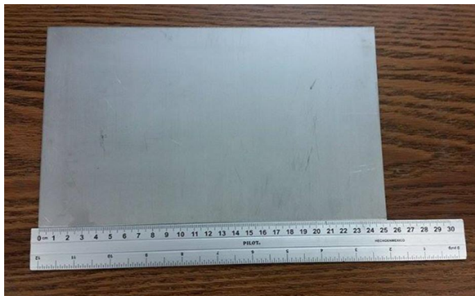
Figura 2. Placa de acero inoxidable 409
