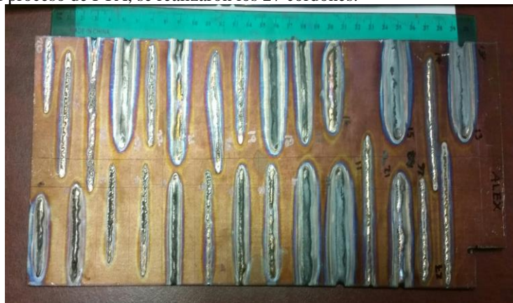
Figura 3. Cordones de soldadura con el equipo PTA.
