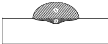
Figura 1. Dilución = B / (A+B) \times 100 (Gardner L., 2016).
