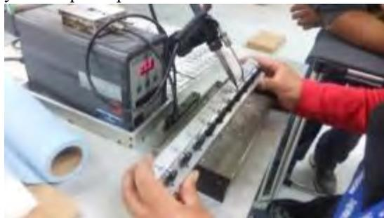
Figura 1. Proceso de soldadura manual
