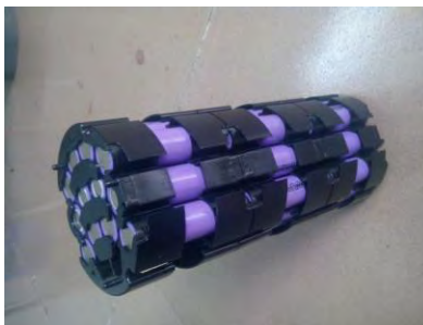
Figura 5: celdas para construir una batería de polímero de Litio (LiPo) para la puesta en marcha de la bicicleta eléctrica.
