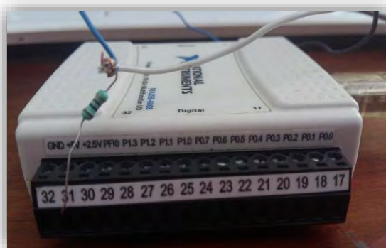
Figura 3. Conexión en la salida digital USB-6008.
