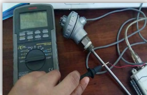
Figura 1. Medición del voltaje del sensor.
