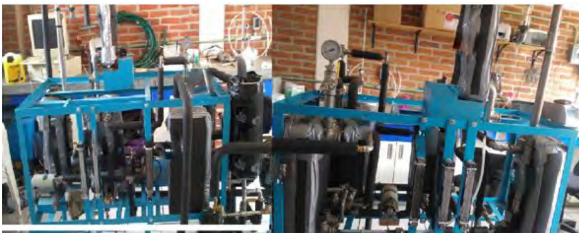
Figura 1. Prototipo de laboratorio para análisis de variaciones térmicas en un ciclo de absorción – UAEM.
