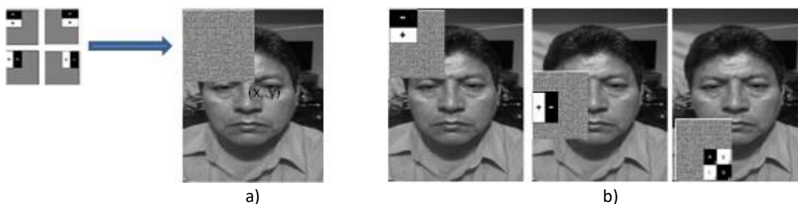
Figura 2. Imagen integral y convolución de filtros en el rostro
