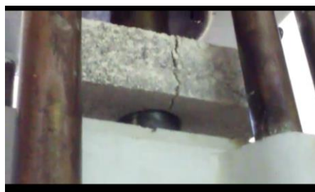
Fig. 3. Pruebas de compresión a Blocks de tepezil
