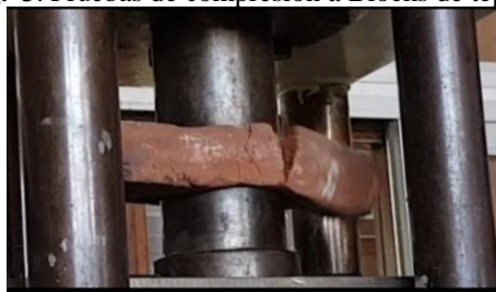
Fig. 4. Pruebas de compresión ladrillo rojo de arcilla
