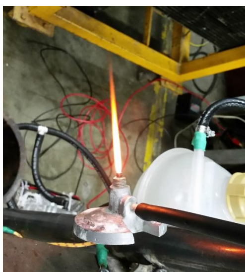
Figura 5. Llama obtenida con hidrógeno obtenida mediante el banco de HHO usado
