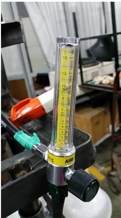
Figura 4. Medición del flujo de HHO generado
