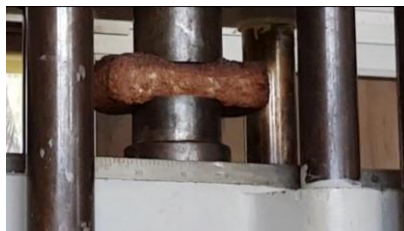
Fig. 5. Pruebas de compresión a ladrillo fabricado a base de cascara de coco “Cocotzil”
