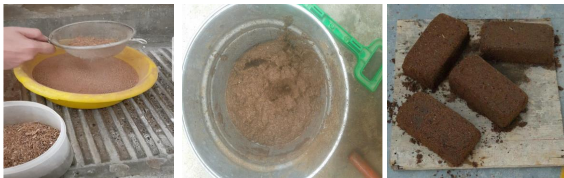
Fig. 1. Proceso de elaboración de tabiques a base de cascara de coco –Cocotzil-
