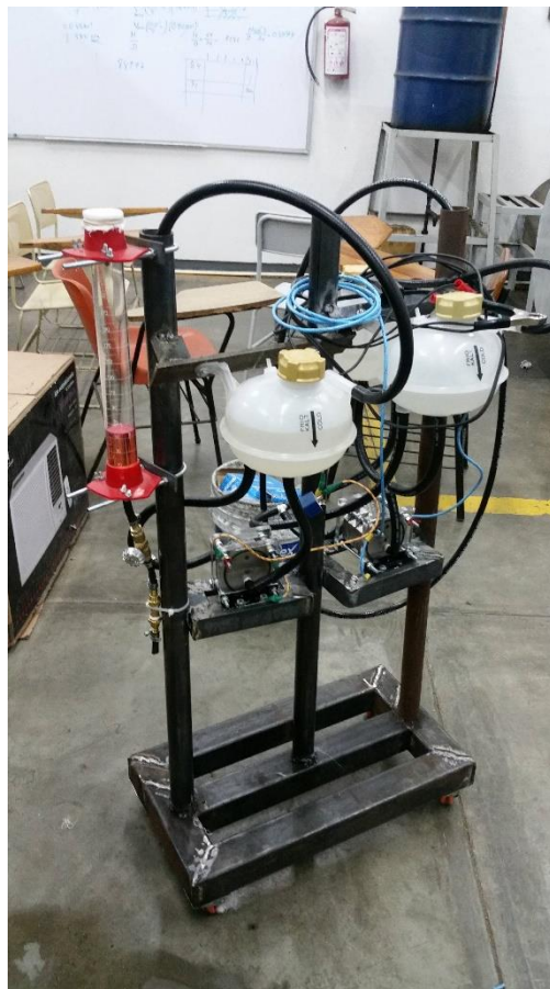
Figura 3. Sistema de generación de hidrógeno.
