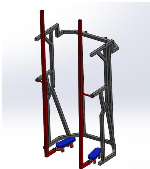
Figura 8. Representación del dispositivo ensamblado en un bipedestador.
