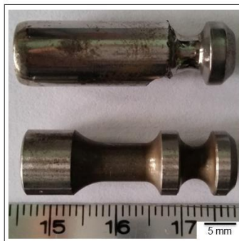
Figura 1. Perno original y perno sustituto modificado en S, utilizados en este estudio.
