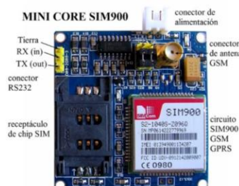
Figura 9 Módulo GPRS/GSM basado en el SIM900.
