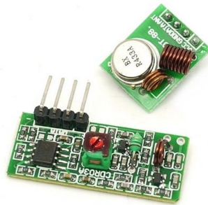
Figura 4. Módulos transmisor y receptor de RF para proyectos de corto alcance.
