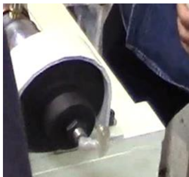
Figura 11. Material Extruido en perfil de poliamida 6 virgen.
