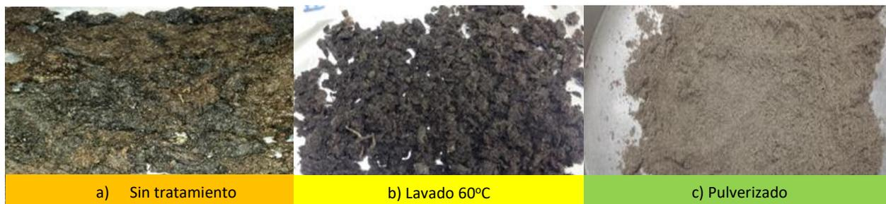
Figural. Pelambre en recepción, después de lavado y por ultimo molido y tamizado.
