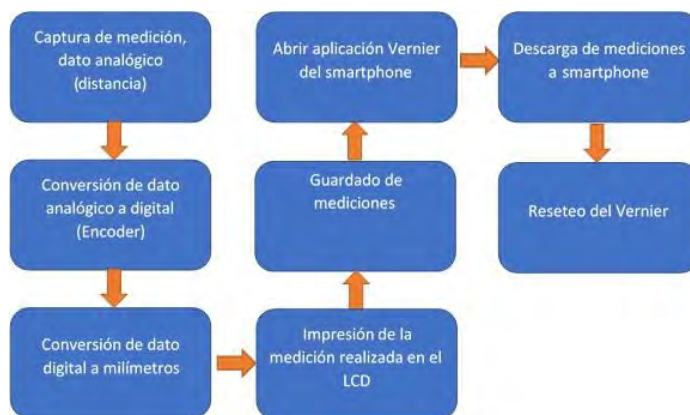
Figura 7. Ilustración del proceso de medición del vernier digital inalámbrico.
