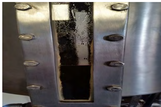
Figura 9. Lavado del biocombustible en el tanque con agua.
