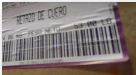
Figura 4. Prueba de Etiqueta (Etiqueta de Papel Normal y Adhesivo Mejorado). Fuente: Elaboración Propia.
