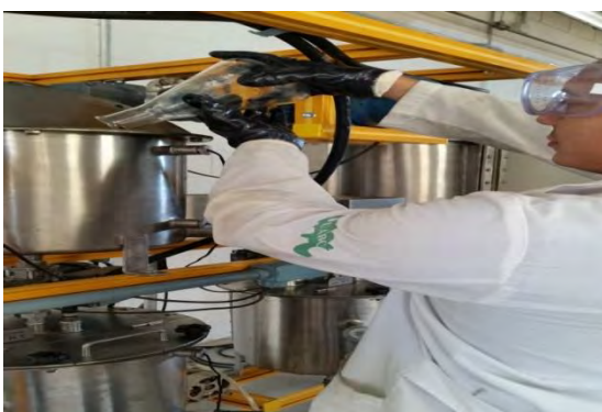
Figura 4. Abastecimiento del catalizador al tanque.
