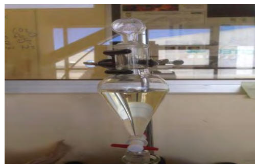
Figura 2. Matraz de decantación para obtención del biodiesel.
