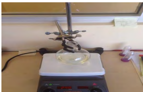
Figura 1. Mezclado del biodiesel en el agitador magnético.
