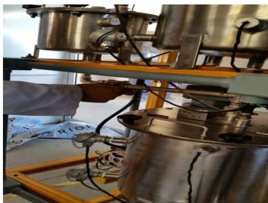
Figura 7. Apertura de válvula para el mezclado en el tanque de reacción.
