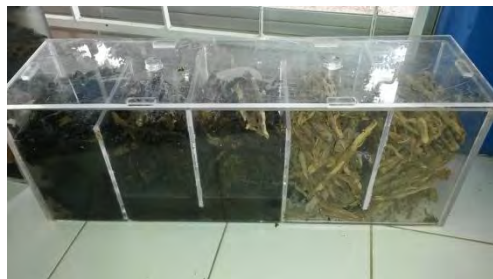
Figura 1. Primer contenedor (A) empacado de cardenche activado.
