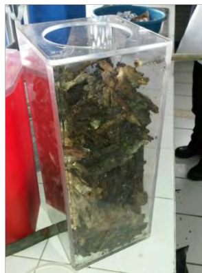
Figura 2. Segundo contenedor (B) empacado de cardenche activado.
