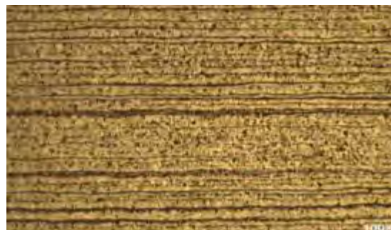
Figura 4 b. Micrografía del acero después de tratamiento de normalizado
