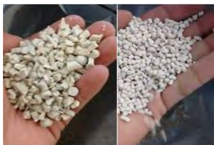
Figura 2. Poliamida-6. Reciclado y virgen.
