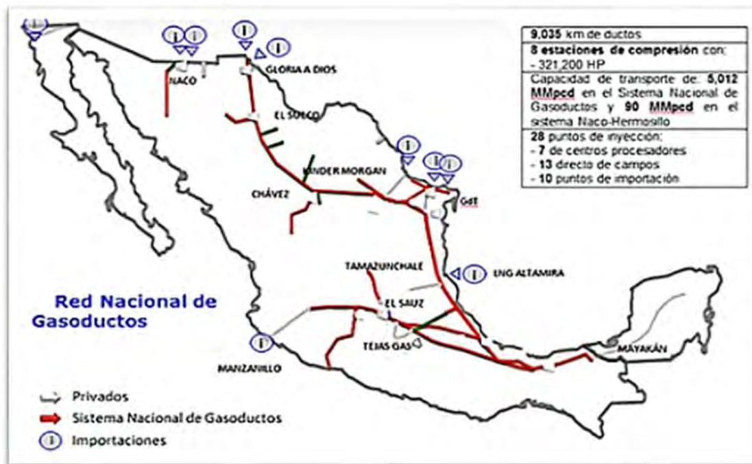
Figura 1. Red Nacional de Gasoductos
