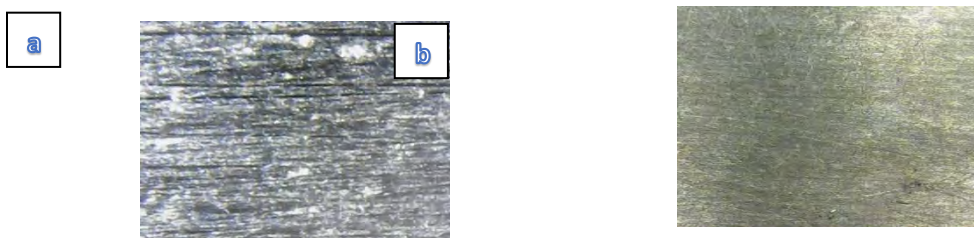
Figura 3: Imágenes 500x de los electrodos (a) electrodo rayado con papel de lija P50, (b) electrodo sin pulido (microscopio marca Digital Microscope magnification)
