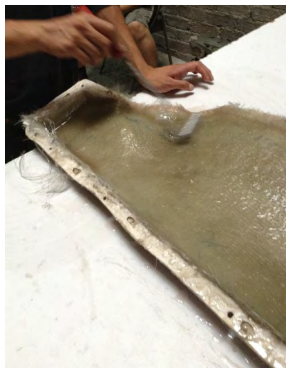
Figura 5. Rodillado de la fibra.
