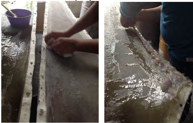
Figura 7. Limpieza y aplicación de cera en las piezas.
