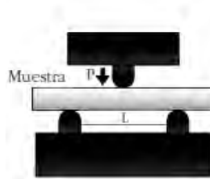
Fig.4. Ensayo de flexión en tres puntos.
