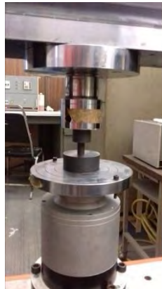
Fig. 3. Ensayo de compresión.
