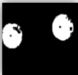
Figura. 6 Segmentación para obtener la matriz simple de escala de grises, entrega un solo valor entre 0 y 250 para calcular el grado de luminosidad de la imagen.
