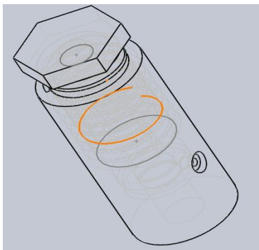
Figura 7. Válvula con alivio de presión a un costado (Fuente: Creación Propia.)
