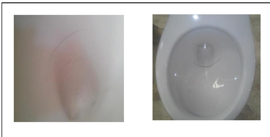
Figura 2 Grieta en una pieza cruda y en pieza cocida.
