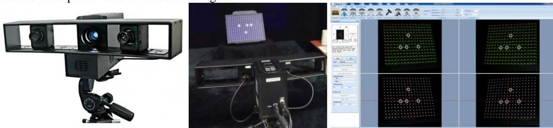
Figura 1.- Escáner 3d y su proceso de calibración.
