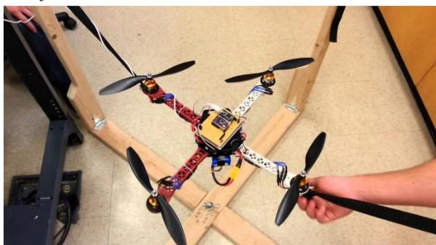
*Ilustración 3 Base de pruebas sujeta con elásticos [3]*
