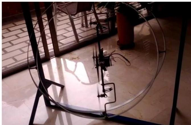
*Ilustración 5 Base de Pruebas Metálica para el control de dos Ejes [4]*
