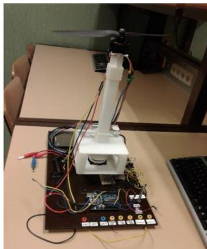
*Ilustración 1 Base para el modelado de un motor [1]*
