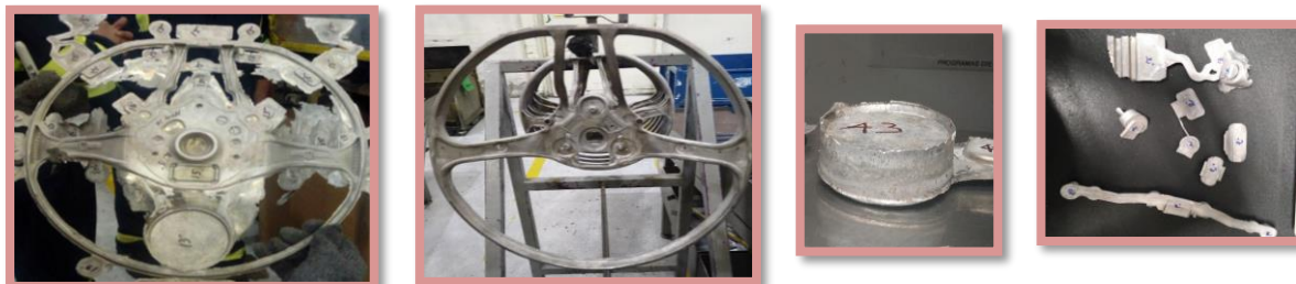
Figura 6. Armadura sin troquelar, troquelada, pastilla y sobrantes
