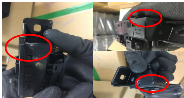
Figura 2. Piezas dañadas en retorno de material
