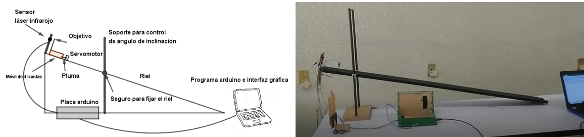
Figura 2. Esquema del montaje y foto de prototipo
