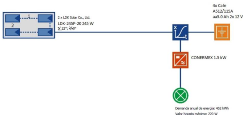
Figura 2. Diseño esquemático del sistema aislado para la instalación de 32 plantas solares fotovoltaicas aisladas en zonas marginadas del estado de Zacatecas (Gámez J. M. et al. 2014).
