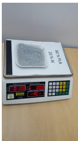
Figura 1 Mezcla de PLA con polvo metálico de Aluminio (80% PLA y 20 % Al).
