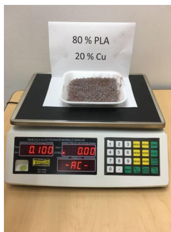
Figura 1 Mezcla de PLA con polvo metálico de Cobre (80% PLA y 20 % Cu).
