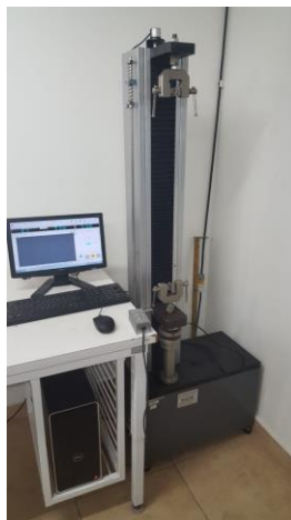
Figura 4 Máquina de tensión, flexión y compresión modelo: WDW-S5. Fuente: MYPESA.
