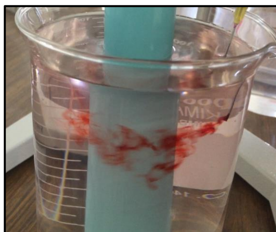
Figura 4 - Tubo concéntrico de 1.2 in, en un fluido Newtoniano a 350 rpm
