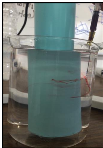
Figura 5 - Tubo concéntrico de 1.06 in, en un fluido Newtoniano a 12 rpm
