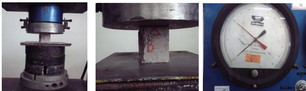
Figura 3: Ensayo de resistencia a compresión de morteros en la maquina Universal
