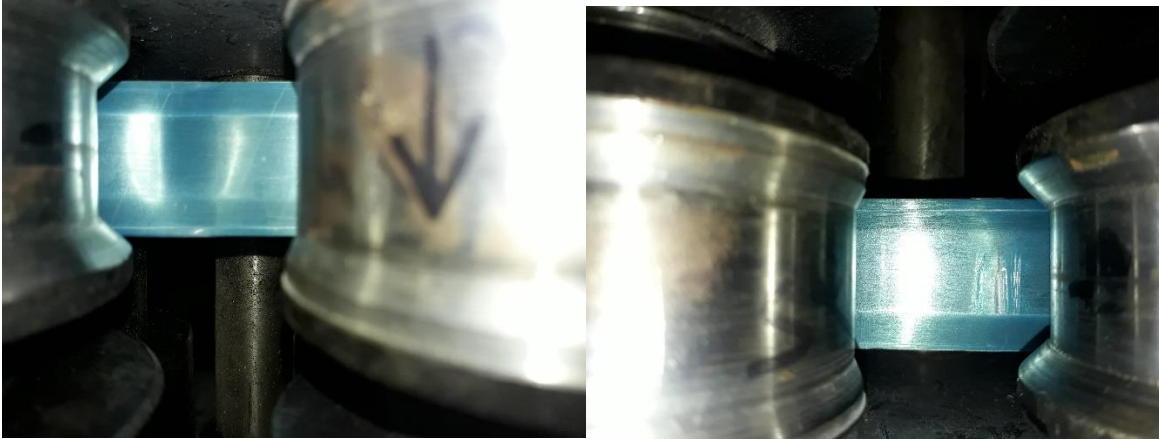
Figura 6 Desalineación de rodillos.
