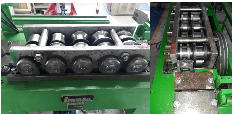
Figura 17 Estado final de la máquina roladora.
