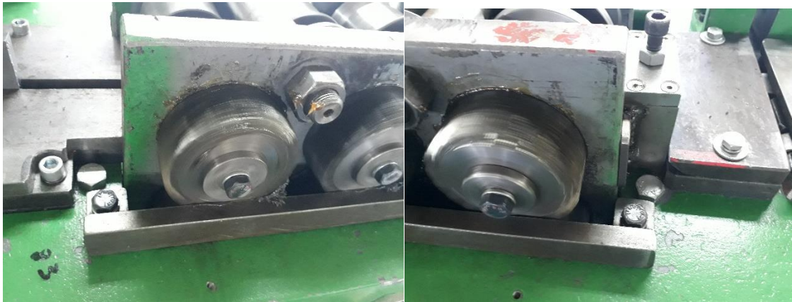
Figura 16 Soporte para evitar que los engranes se muevan.
