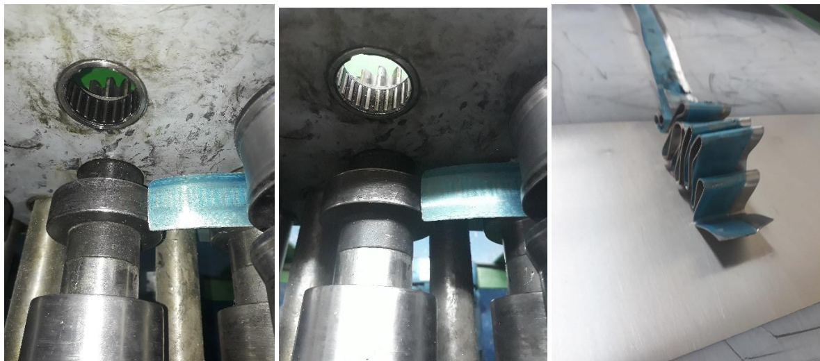
Figura 5 Estación No.2 perfil con curvatura.
