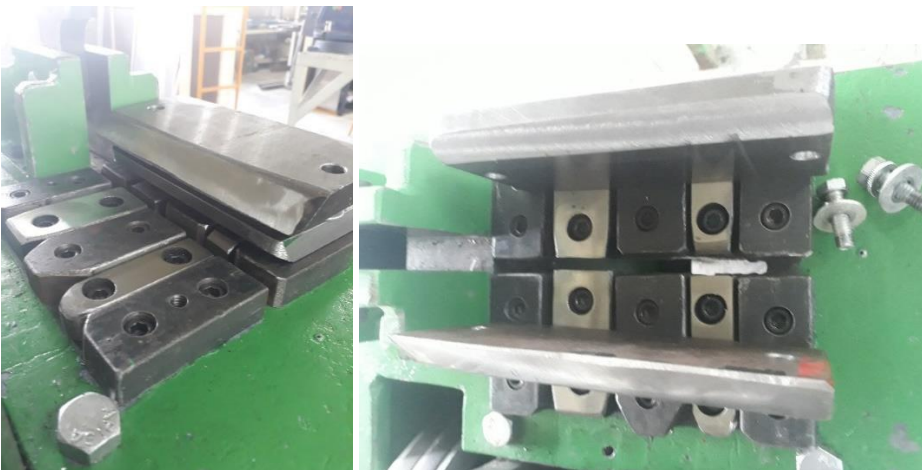
Figura 14 Placas superiores con ángulo para evitar que se atore el perfil.
