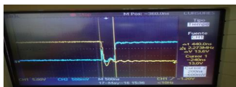
Figura 12. Tiempo muerto de 440 nseg. entre transistores de la misma rama.
