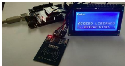
Figura 3. Muestra del circuito en el MC, que libera el acceso del recurso energético en el aula, identificando al profesor y el horario en el que debe trabajar en el área, previa consulta a la base de datos.
