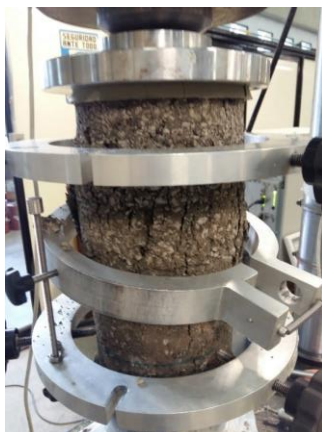
Figura 3. Prueba de resistencia a compresión
