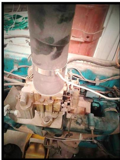
Figura 2. Termopar en la admisión.
