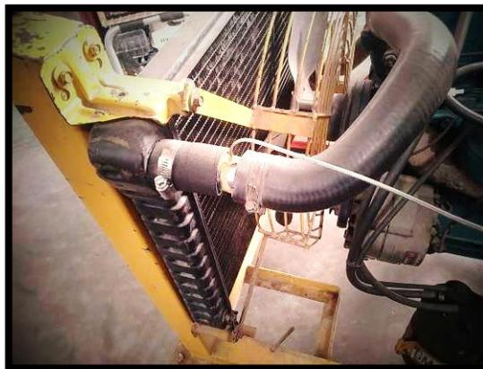
Figura 3. Termopar en el radiador.
