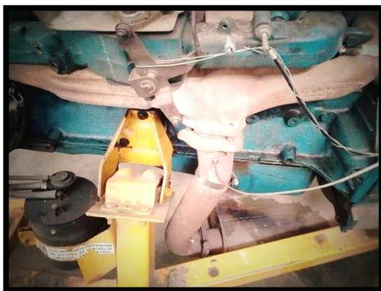
Figura 4. Termopar en el escape.
