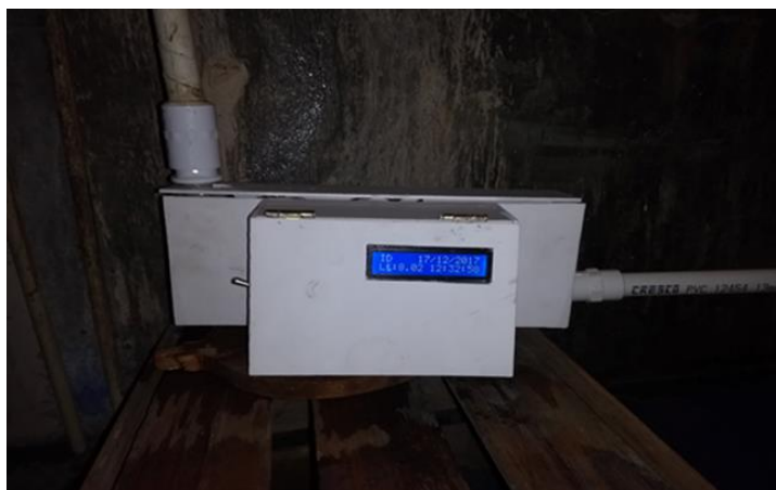
Figura 2. Prototipo de medidor digital hídrico en operación.
