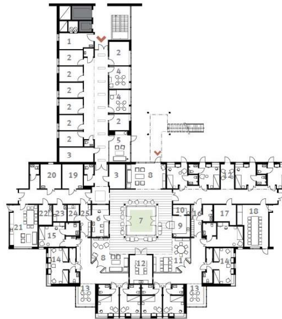
Figura 3. Planta arquitectónica tipo de la Unidad de Cuidados para pacientes psiquiátricos de Ostra Hospital (From & Lundin, 2010).
