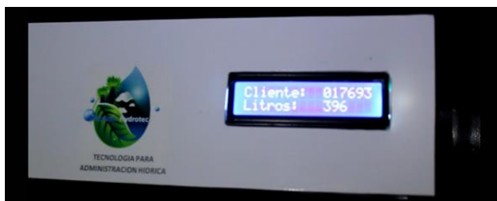
Figura 1. Prototipo de Medidor Digital indicando el ID de Cliente y consumo en litros de agua
