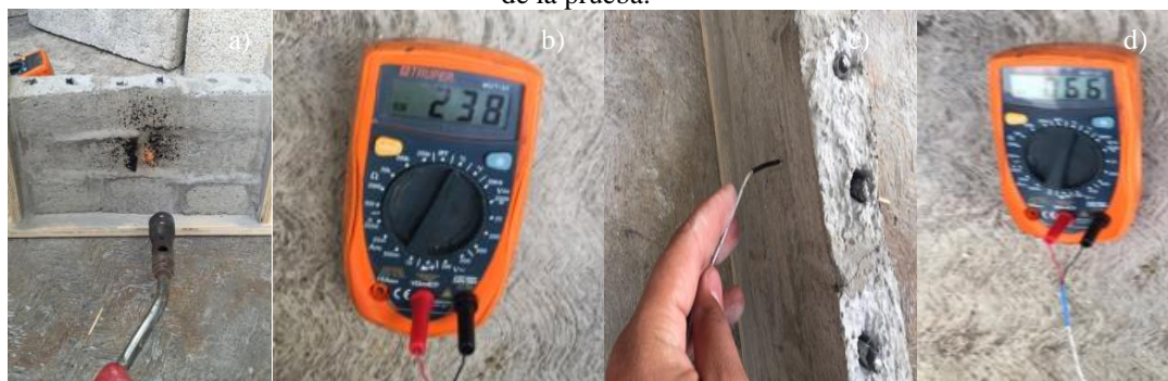
La figura 5, muestra la prueba de conducción térmica practicada a los bloques propuestos.
