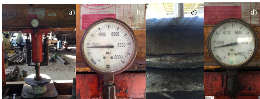
Figura 2. Pruebas mecánicas de los materiales comerciales. La imagen a) muestra la prueba de compresión del block de concreto, la imagen b) muestra la resistencia antes de la fractura. La imagen c) muestra el tabique de barro siendo comprimido y la imagen d) muestra la resistencia del tabique.
