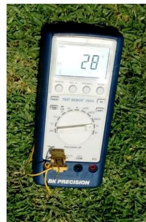
Figura 5. Multímetro Digital con Termopar tipo K.
