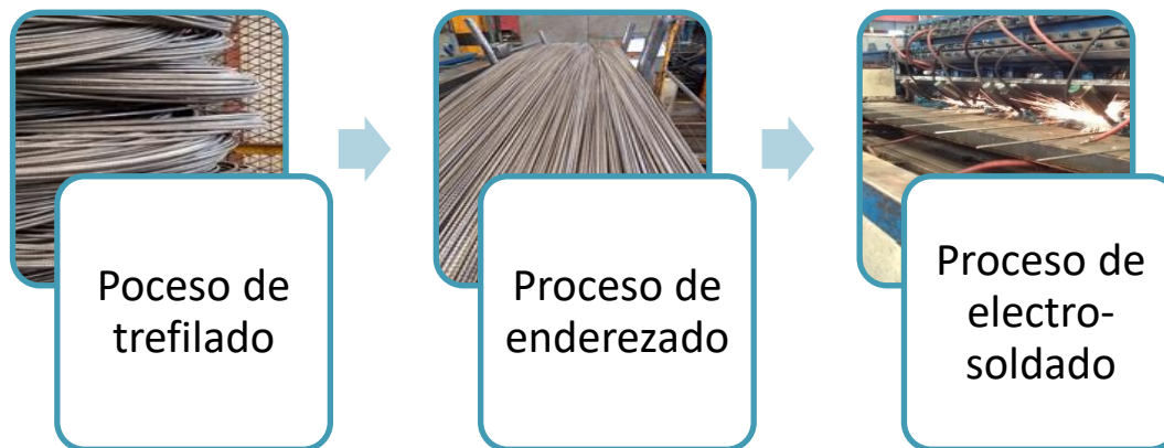
Figura 1. Esquema general del proceso de producción de la malla electro-soldada. Elaboración propia
