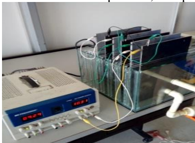
Ilustración 2 Colocación de las placas de aluminio y acero
