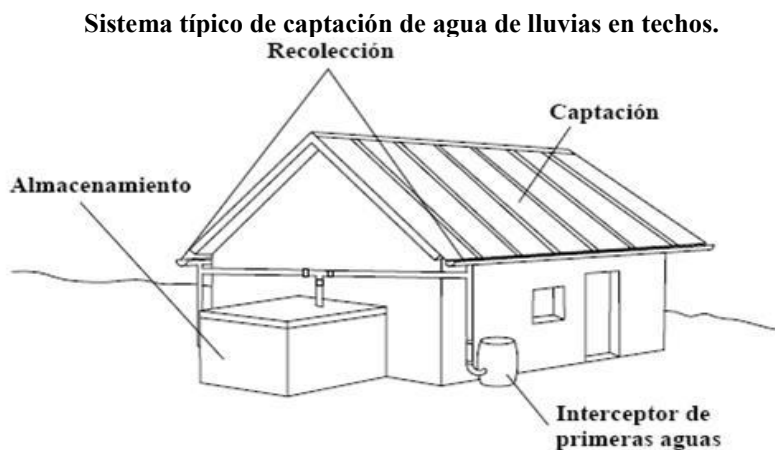
Figura 1. Fuente: Guía de Diseño para Captación de Agua de Lluvia. CEPIS, 2004.
