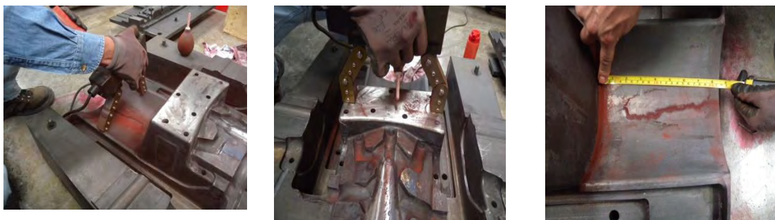
Figura 4. El campo magnético es aplicado sobre el herramental, por medio de un soplo de aire se dispersan las partículas magnéticas haciendo un imán sobre la grieta, se localiza e identifica.
