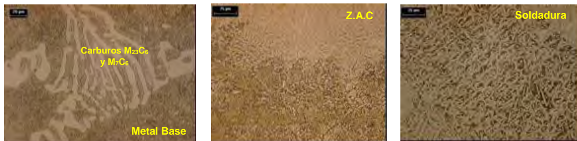
Figura 6. Martensita revenida con carburos de Cromo y Molibdeno M_{23}C_7 y M_7C_6 dispersos en la matriz
