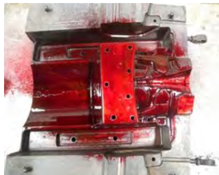
Figura 2.- Se aplica la técnica de líquidos penetrantes bajo la norma ASTM E165 y E433
