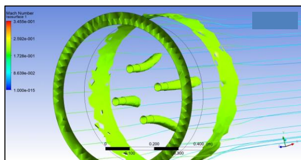
Figura 9. Isosuperficie de interés para Ma=0.2 en la sección de entrada.
