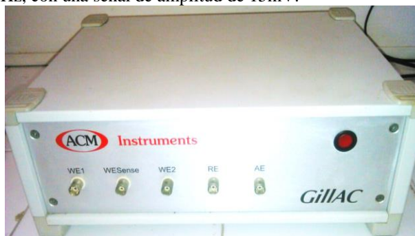
Figura 1. Potenciostato usado en la valoración electroquímica
