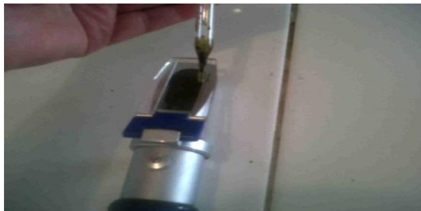
Figura 4. Determinación de °Brix en muestras de planta stevia con refractómetro
