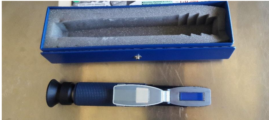
Figura 1. Refractómetro de mano para determinar porcentaje de azúcares Fuente: elaboración propia.
