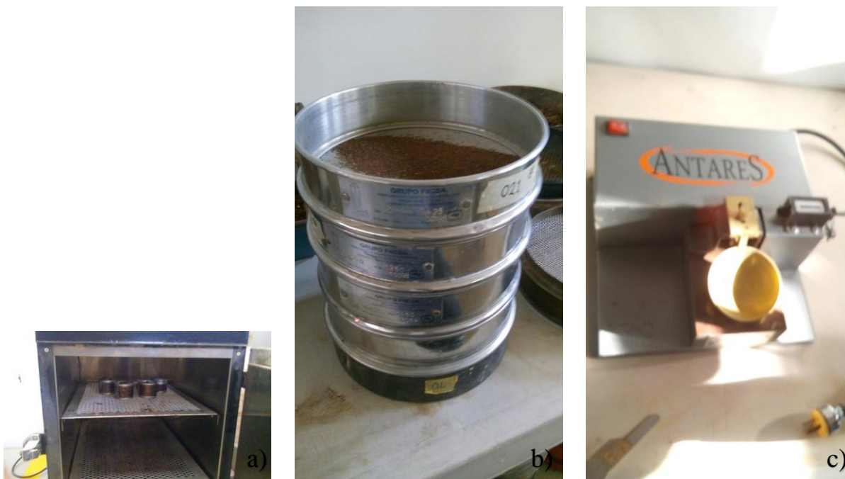
Fotografía 3. Pruebas a las muestras recolectadas: a) Contenido de Humedad, b) Granulometría Completa y c) Límites de Consistencia.
