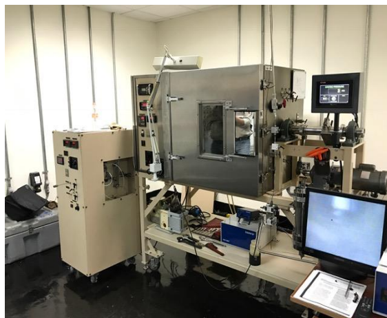
Figura No 2. Celda para análisis de líquidos, PVT, de 15 000 psi.
