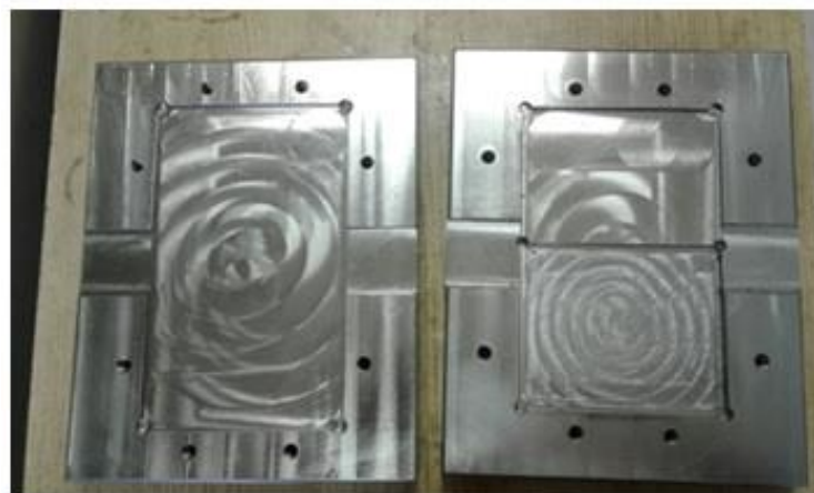
Figura 4. Fabricación del portamuestras de materiales disimiles
