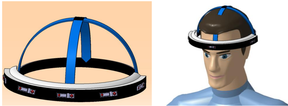
Figura 4.- Segundo diseño de la diadema para personas invidentes y débiles visuales
