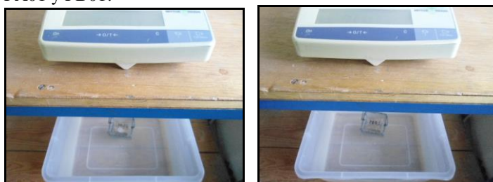
Figura 8. Fotografías del peso suspendido de las probetas PA01 y PB01
